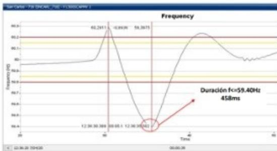
Actuación de la primera etapa del Esquema de Desconexión Automático de Carga (EDAC)
