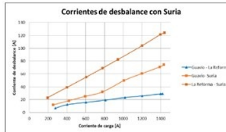
Figura 60. Corriente de desbalance 3I0 línea LR-GV2 y GV-S-LR con subestación Suria
